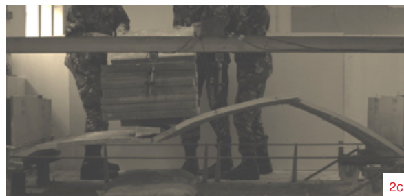
Colapso: formação das rótulas plásticas (Carga Linear)
