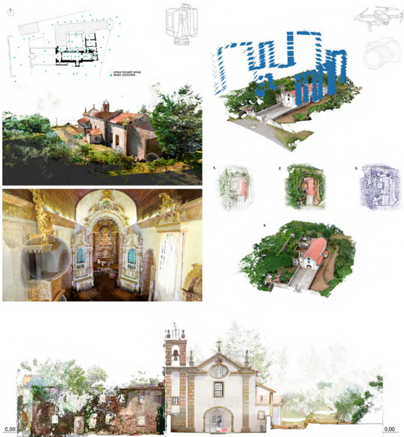
31 Levantamento 3D com varrimento laser (esquerda), fotogrametria aérea e terrestre (direita), e alçado, resultado da integração das técnicas. © Rolando Volzone, Roberta Ferretti e Pietro Becherini, F-Atlas, 2022
