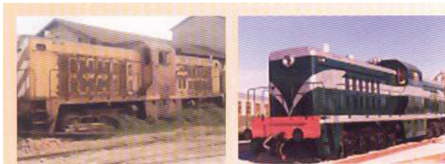
Locomotiva: antes e após trabalhos de recuperação. Trata-se da primeira locomotiva recuperada nas oficinas da EMEF (Empresa de Manutenção do Equipamento Ferroviário).
