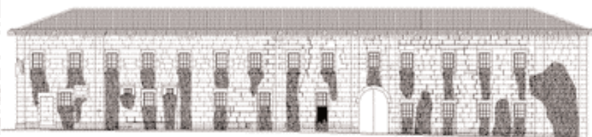
Fig.3 - Mapeamento das anomalias detectadas no alçado lateral direito (Sul).
