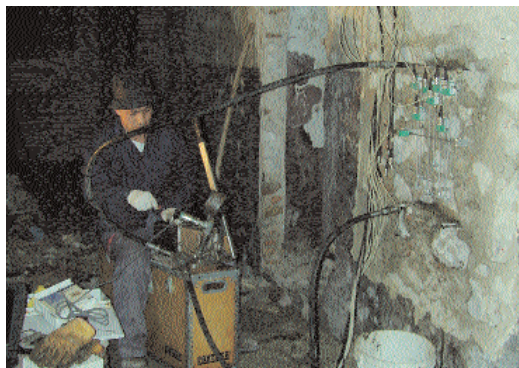
Fig. 2 - Execução de um ensaio com macacos planos duplos.
