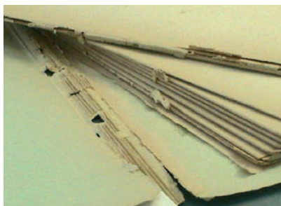
Dois exemplos de amarelecimento provocado por hidrólise ácida da celulose
