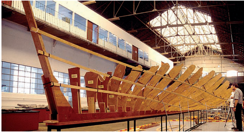
3. A maquete de estudo do casco do navio Ria de Aveiro A, em 2D, à escala de 1:1, constitui por si só uma eloquente e mediática peça museológica
