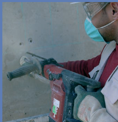
Recolha de pó do betão a diferentes profundidades para determinação do perfil de cloretos
