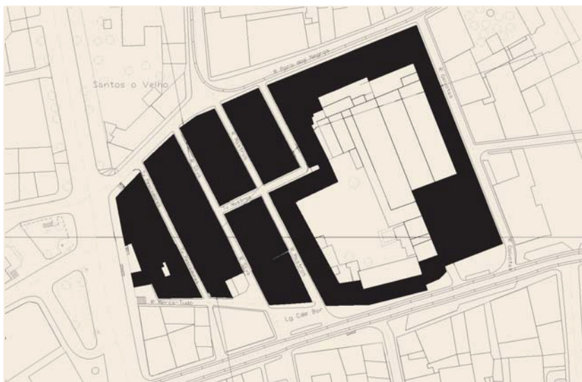
Duas categorias de edifícios são visíveis, os de “frente” e os de “topo” de quarteirão, que se dividem em três tipos: um resultante do módulo-padrão inicial, outro da sua divisão e um terceiro da adição de outro módulo-padrão...
