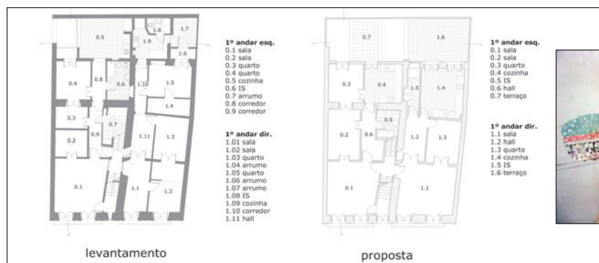
7 – Rua de S. Bento, n.º 306, planta do 1.º andar (antes e depois da intervenção)
