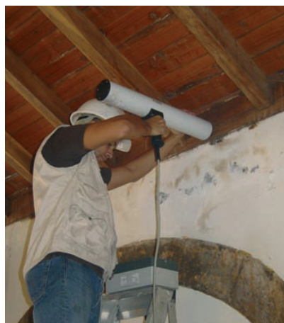
6 - Ensaio de resistografia em freixal
