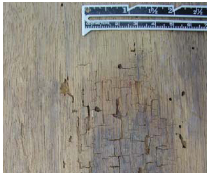
Início do desenvolvimento de podridão cúbica, ocasionada por fungo xilófago (Pintura sobre carvalho do séc. XVI)
