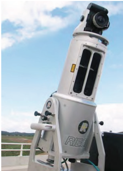
Fig. 2 – Equipamento terrestre de varrimento laser e câmara fotográfica digital
