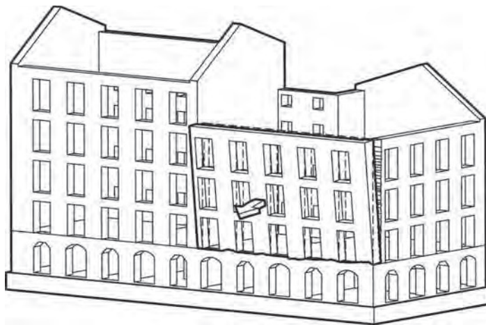
Fig. 3 – Mecanismo de colapso por derrubamento de uma parede de fachada de um edifício pombalino por acções fora do seu plano
