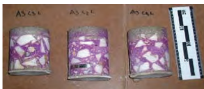
Fig. 4 – Determinação da profundidade de carbonatação dos betões sobre carotes
