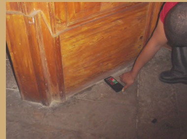
Fig. 5 - Sub-coro. Medição da humidade superficial na base do guarda-vento de madeira, indicando superfície muito húmida
