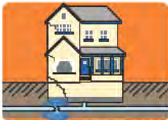
Roturas em condutas
